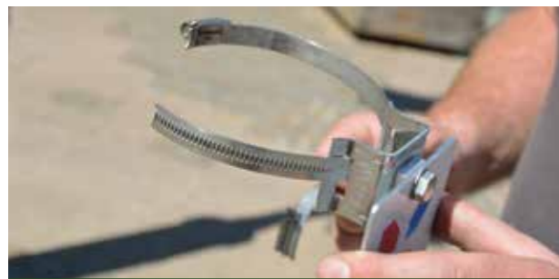
Variante a: mit Schlauchschelle und U-förmigem Halter (verstellbare Größe des Bandes)
