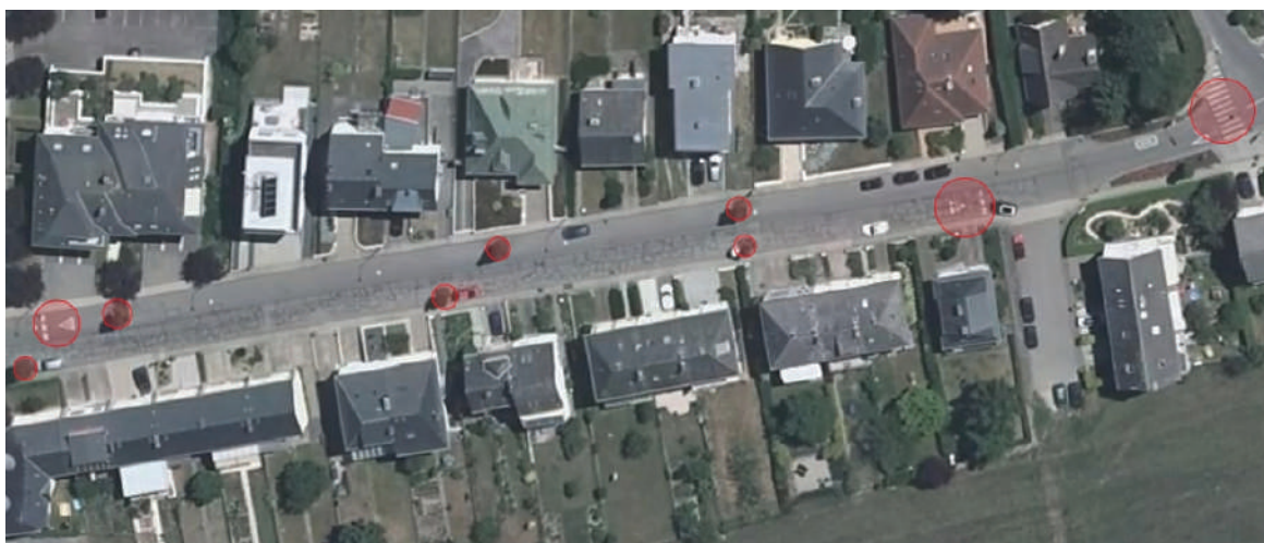
Abb. 7.: Satellitenbild einer Straße mit baulichen Maßnahmen zur Verkehrsberuhigung (Quelle: MMTP)
